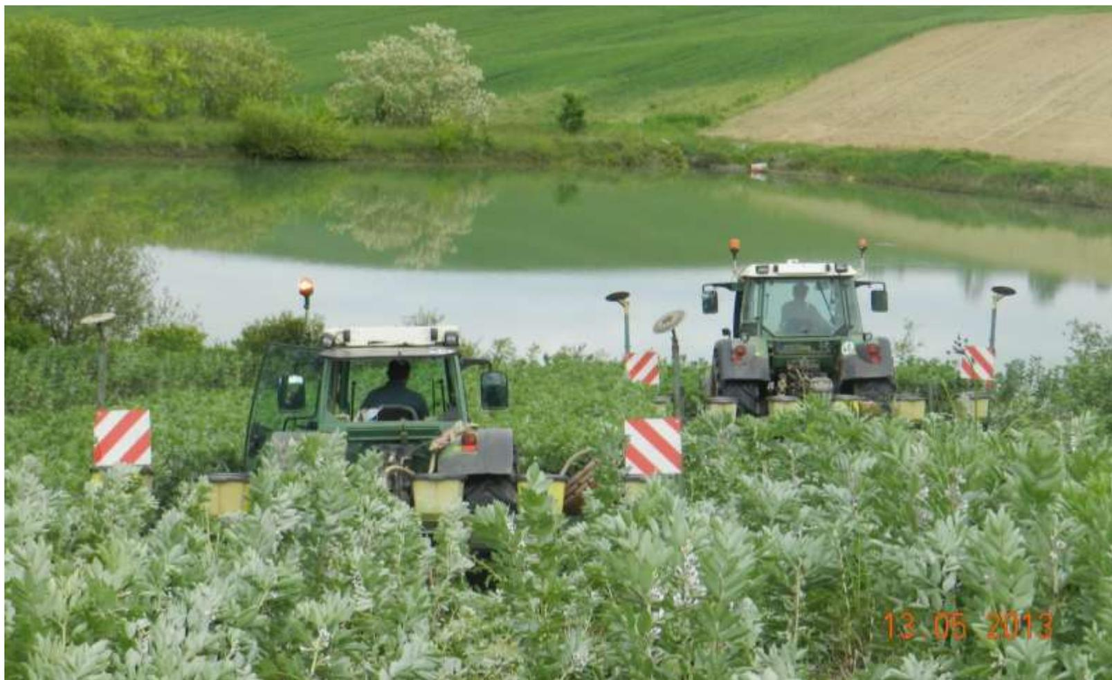
**13/05/2013** : essai comparatif du semoir prototype par rapport à la référence
